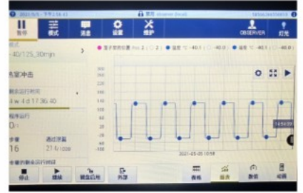
-40/125°C 各30min 冷热冲击测试
