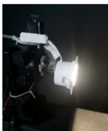
LED射灯光生物安全测试
