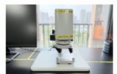
2D-3D测量显微镜
