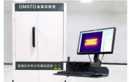
显微红外热分布测试系统
