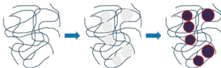
上图表示的是VOC气体在硅占据的空隙中，随着热和光子能量的作用，VOC气体产生变色现象。
