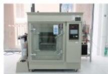
混合气体腐蚀试验箱
