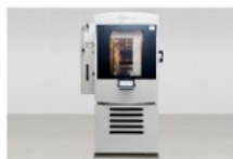
循环腐蚀性气体试验箱
