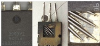
激光开封系统逐层开封
