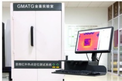
显微红外热点定位测试系统
