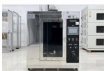
漏电流试验机
