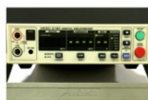
绝缘电阻测试仪
