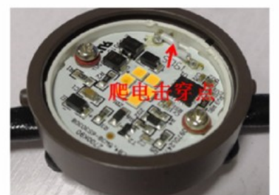
耐压试验期间出现爬电击穿
