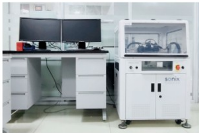
超声波扫描显微镜 (SAT)
