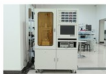
热阻及导热系数测试设备
