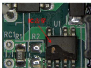
在1KV雷击浪涌测试中IC击穿损毁
